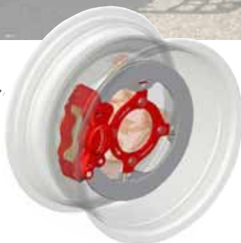
conjunto disco-pinza en la rueda de- lantera (rueda de 10")
