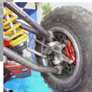
conjunto disco-pinza en la rueda de- lantera (rueda de 10")
