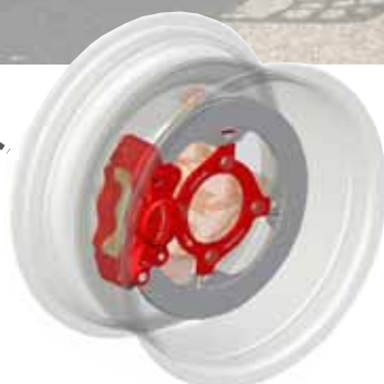
Bremsscheibe und Bremszange im Vorderrad
