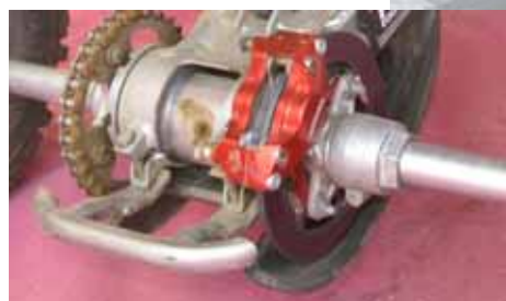
Bremsscheibe + Bremszange + Adapter
