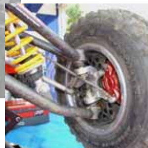
Bremsscheibe und Bremszange im Vorderrad
