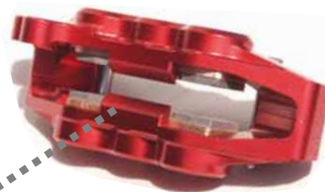
Chanfrein de guidage du disque
